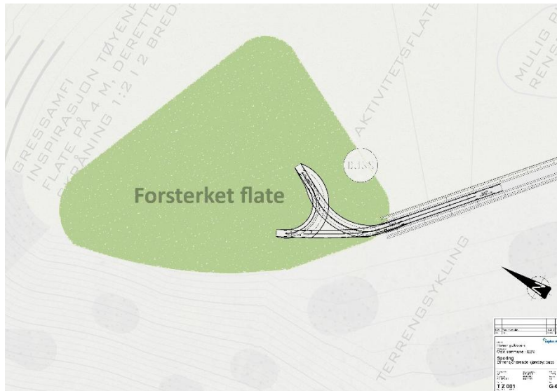
Figur 41 Illustrasjonen viser sporingskurver for buss når den skal snu på den forsterkede flaten i enden av kjørevegen.
