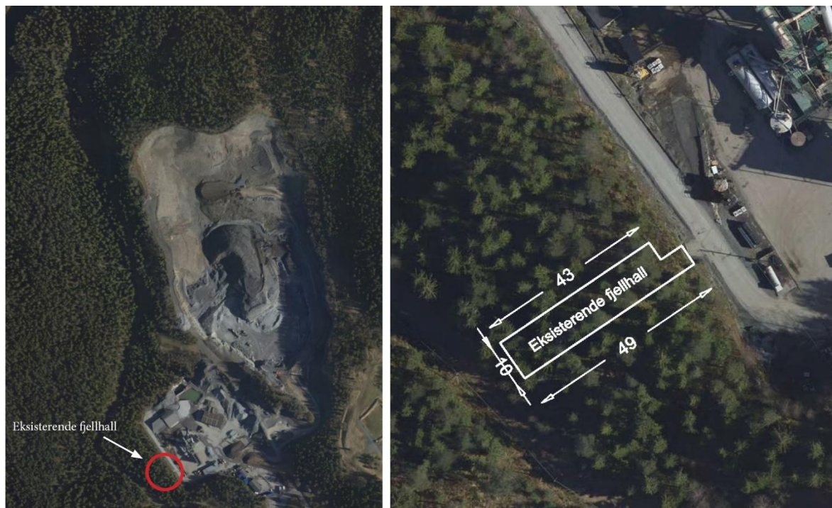
Figur 23 Eksisterende fjellhall og plassering i planområdet. Bildet til høyre viser hallens dimensjoner.
